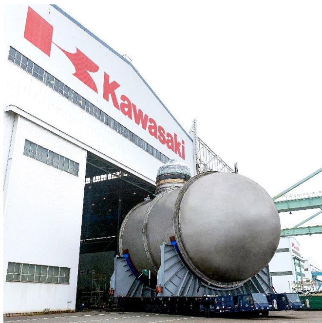
図8 内槽・外槽一体化後のタンクシステムの様子
