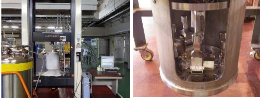
図一 1 0 J IC 試験実施装置 (写真)
