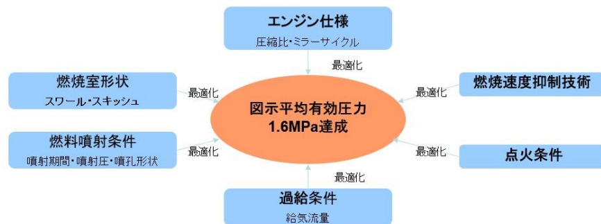
図5 目標図示平均有効圧達成のために検証するパラメータ例
