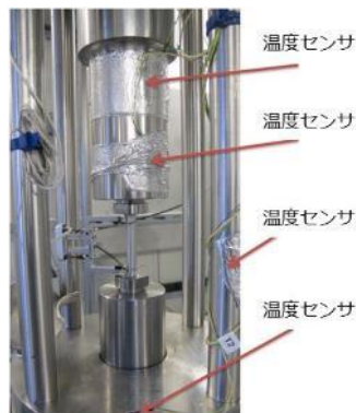
図4 低温水素ガス雰囲気環境 SSRT 試験装置の外観（左）と試験結果（右）
