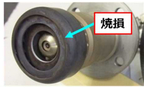
既存の天然ガス用燃料噴射ノズル
