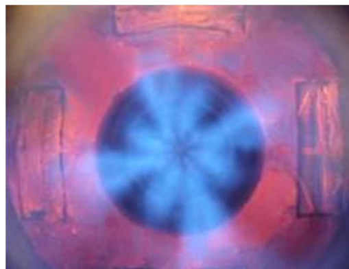
図5b 低振動型ガスノズルの都市ガス燃焼状況 ( I1 = 16 \text{ Pa} : 燃焼振動の兆候無)
