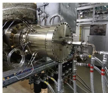
微小火炎型ドライ方式燃焼器試作品と 燃焼器単体試験風景
