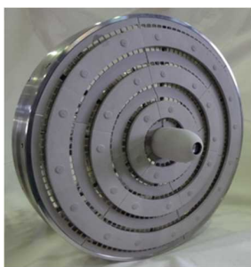
微小火炎型ドライ方式燃焼器試作品と 燃焼器単体試験風景
