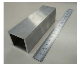
図 開発合金の中空押出例
