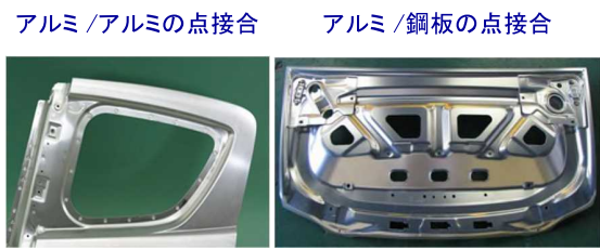
アルミ/アルミの点接合 アルミ/鋼板の点接合 アルミリヤドア (2003～) アルミトランクリッド (2005～)
