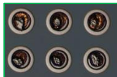
図 2-3.2.3-2 Nb-Nb 接続破断面
