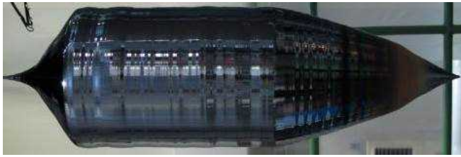
図Ⅲ-2-(二)-A-29 8インチ CZ 結晶シリコン写真とキャリアライフタイムの結晶長さ方向依存性
