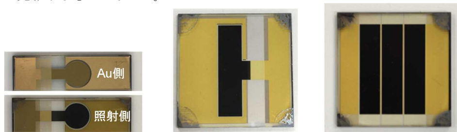
図III-2-(ハ)-G-2. 作製したデバイスの外観：左から 0.18cm 2 セル、1cm 2 セル、2.76cm 2 モジュール
