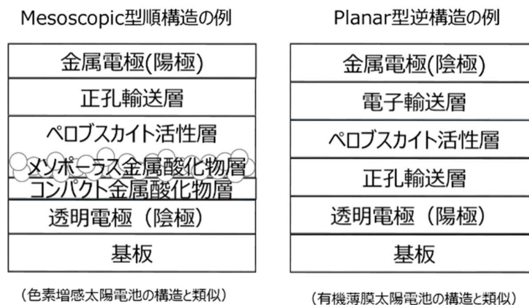
図III-2-(ハ)-B-1 ペロブスカイト太陽電池のセル構造。Mesoscopic型は色素増感太陽電池に、Planar型は有機薄膜太陽電池に類似した構造である。
