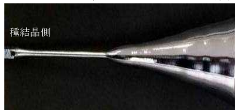
図 III-2-(イ)-E-10 実際のネッキング品
