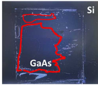
図Ⅲ-2-(ロ)-A-1-b3-4. ELO法によりPETフィルム上に転写されたGaAs 1J層とSiの接合。
