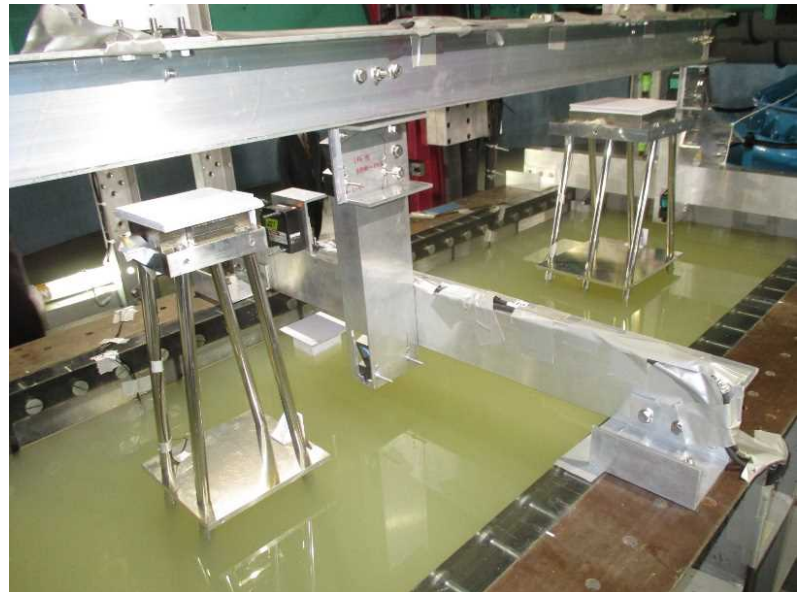
図 3-6-66 模型設置状況 (左 : スカート設置、右 : 架台設置)
