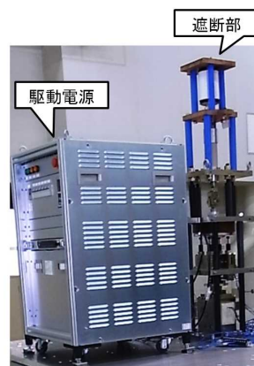
図 3-4-57 遮断部の操作試験概観
