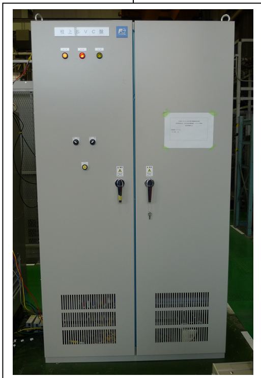
ミニモデル(200V 30kVA, IGBT 使用)
