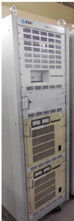
图 5.4(1)-8 PV 模拟装置
