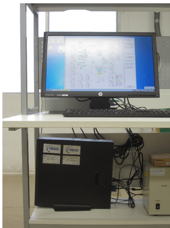
図 5.4(2)-12 配電線センサデータ収集用親局装置
