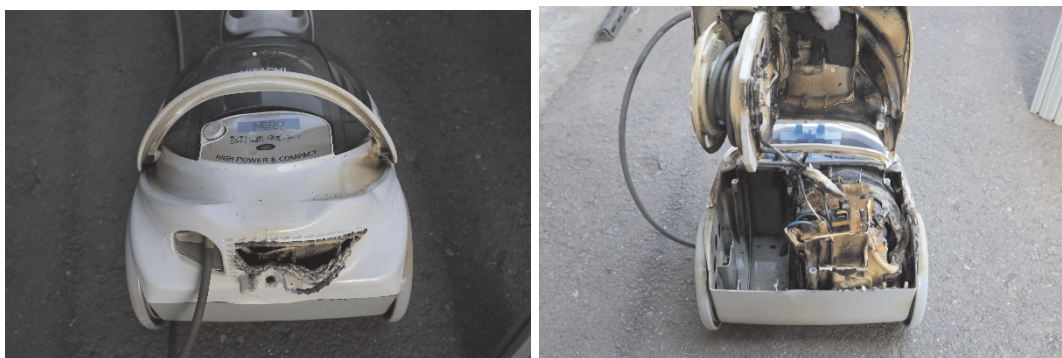
図 2.2.1.3.2-2 発煙した電気掃除機の様子
