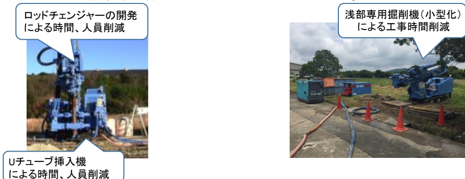
図Ⅲ(1.3)-1 開発した掘削機
