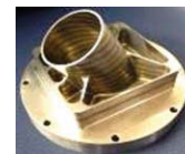
複層造形体の例(シャフト) (合金鋼+SU316L+ステライト)
