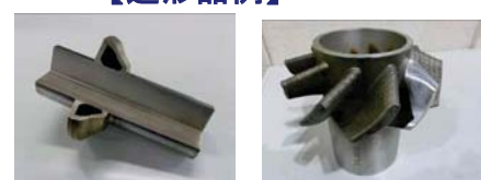
複層造形体の例(シャフト) (合金鋼+SU316L+ステライト)
