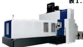
図2.シリーズ機 LAMDA2000 Hybrid DED SYSTEM 造形サイズ: 2500×1400×1500 (計画)
