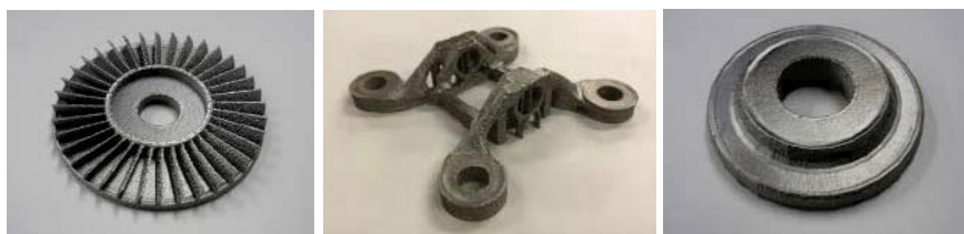
図2.造形事例 フィン(φ100: Ti-6Al-4V) 三次元擬似形状モデル (Ti-6Al-4V) 溶接機部品：スエーピングロール(φ100: Ti-6Al-4V)
