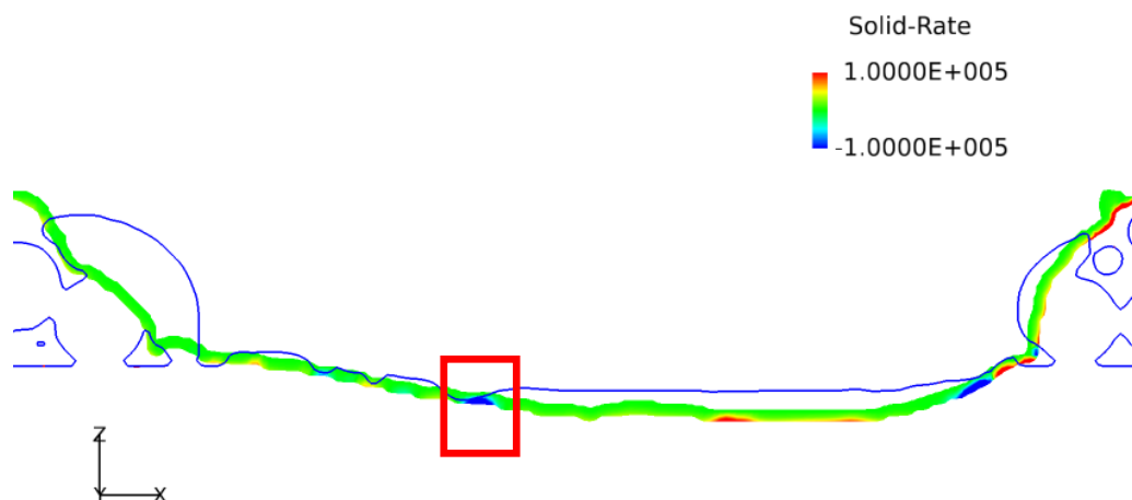
図 2-2-11 捕捉した固液共存領域
