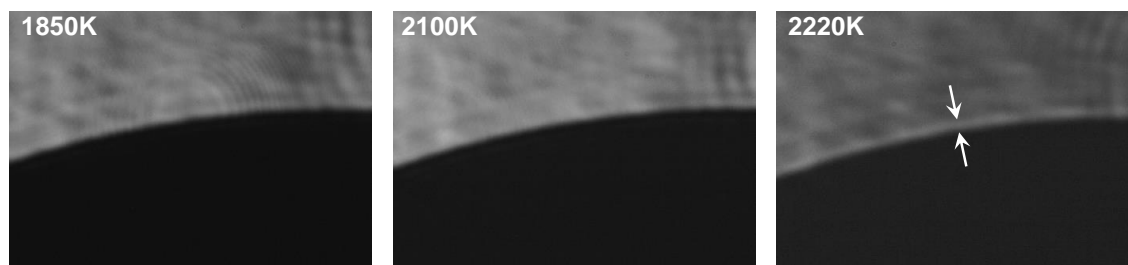
図 2-2-17 浮遊金属気液界面近傍のシュリーレン画像 矢印部分厚みは 35 \mu\text{m}
