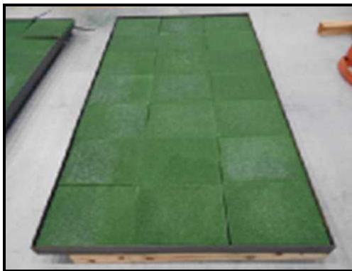
図5 触媒添着セラミックフィルター
