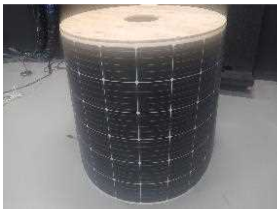
図 2-1 ベンディング試験写真 Sunman製、最小曲げ半径450mm
