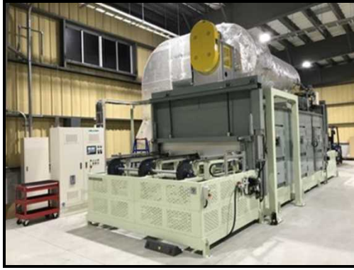
図3 太陽電池パネル熱分解炉写真
