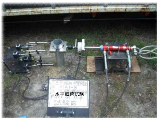
図 37 杭基礎の水平抵抗力の実測調査
