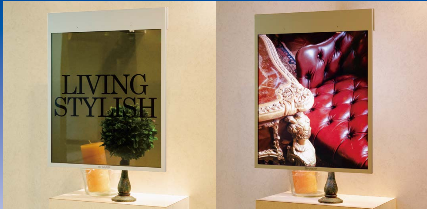
シャープミュージアム（奈良県天理市）に展示されている透明ディスプレイ。左が透明モード、右がカラーモード
