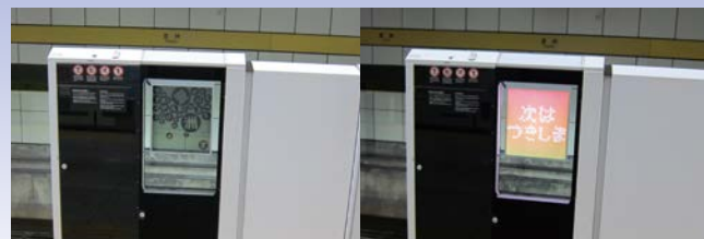
東京地下鉄 豊洲駅の転落防止柵に設置された透明ディスプレイ。左が透明モード、右がカラーモード（資料提供：シャープディスプレイテクノロジー株式会社）
