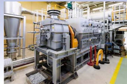
プラスチック付きアルミをプラスチック成分とアルミに分離する乾留炉（乾留式アルミ回収装置）
