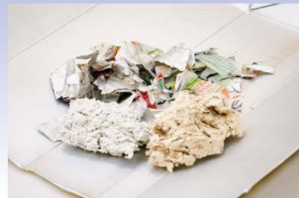
パルパー型分離機で分離回収された紙パルプとプラスチック付きアルミ
