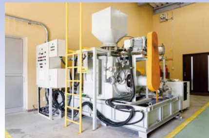
アルミ系廃棄物から紙パルプとプラスチック付きアルミを分離回収するパルパー型分離機
