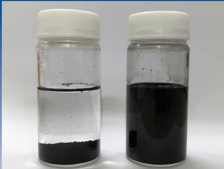
右：ほぐし分散処理を施したCNT、左：ほぐし分散処理を施していないCNT。沈殿具合が異なる（資料提供：株式会社GSIクレオス）
