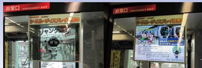
埼玉新都市交通の運転席扉にある窓ガラスに設置された透明ディスプレイ。左が透明モード、右がカラーモード（資料提供：シャープディスプレイテクノロジー株式会社）
