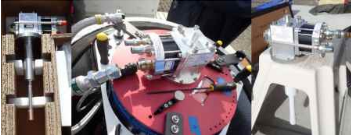
図 2.3.1-2 超伝導重力計 iGrav035 の冷凍機交換作業（左：新品の冷凍機；中：コンプレッサからの冷媒ライン 2 本と電源ケーブルを iGrav 上面で取外した状態；右：取外し直後の冷凍機）
