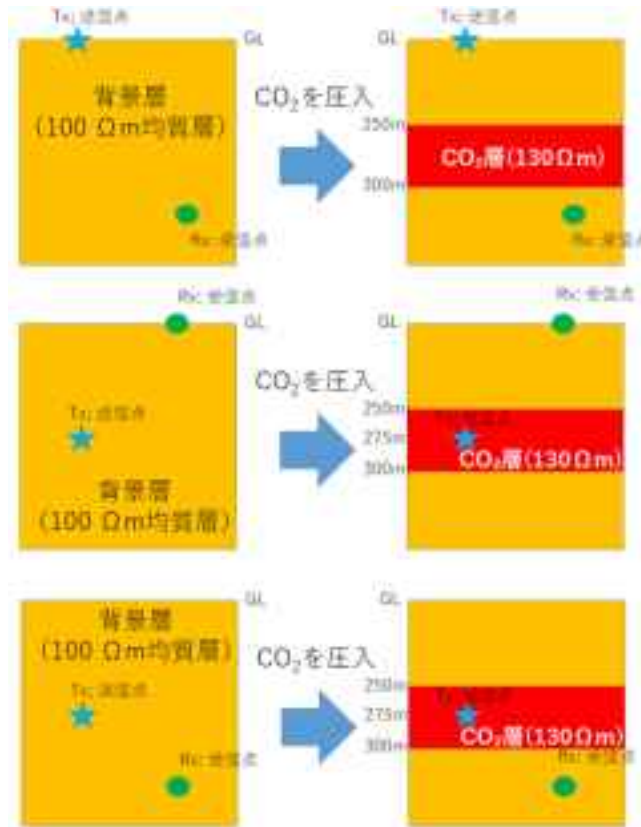
図 2.5.3-1 検討した地下比抵抗モデルと送受信点配置
