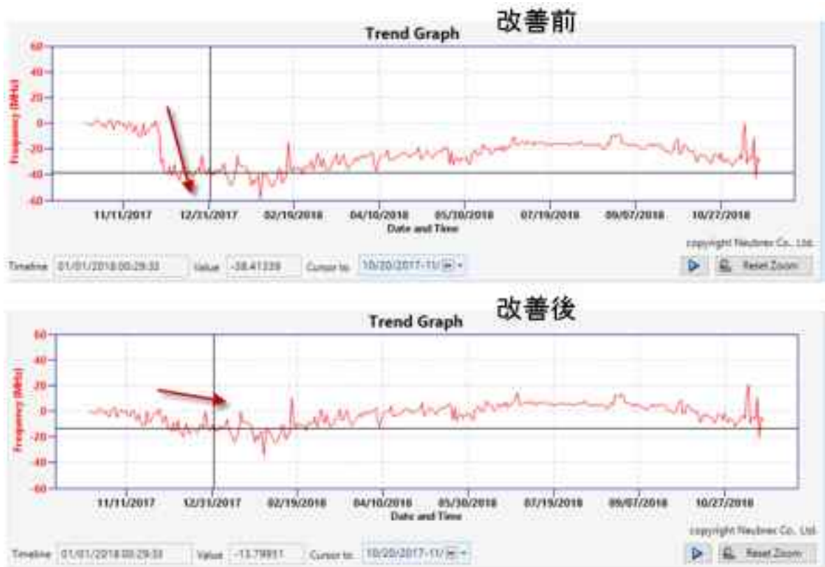
図2.6.3-2 ブリルアン計測での差分計算法の改善前後のトレンド波形
