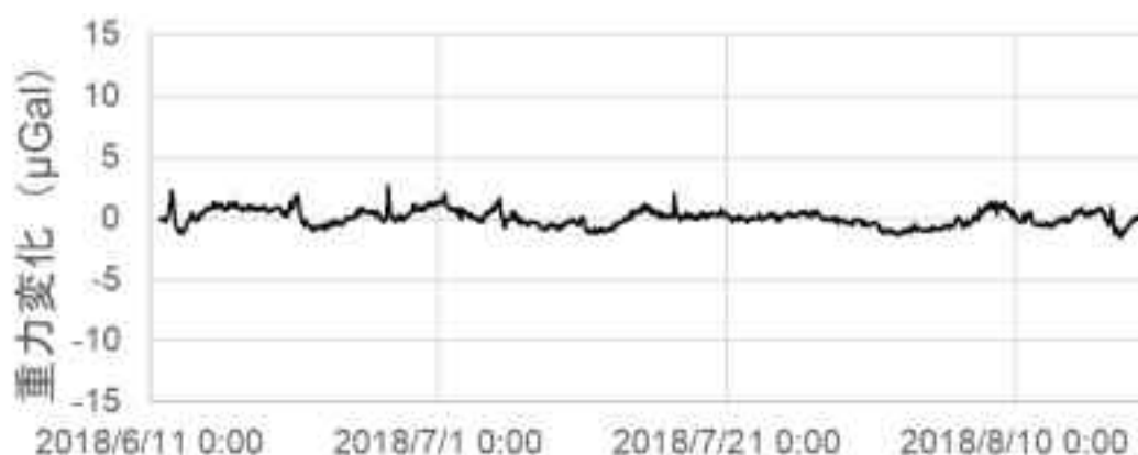
図2.3.2-1 重力変化の観測値から推定値を除した残差の時間変化
