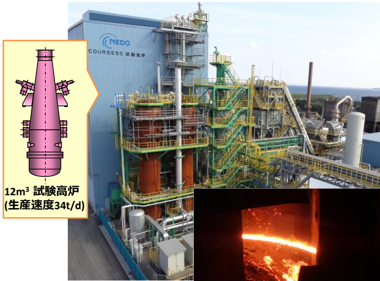
出鉄状況 (溶銑温度: 1473℃)
