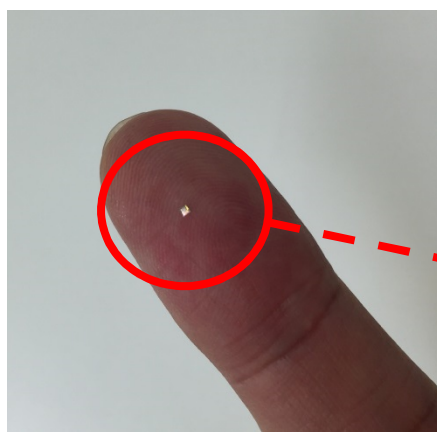
世界最小極小RFIDタグ （サイズ：0.9mm角）
