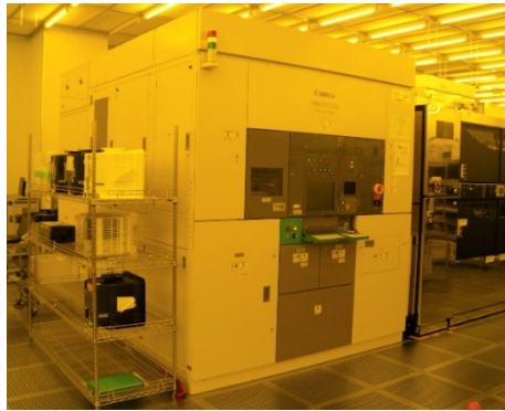
シリコン貫通電極のためのフォトリソグラフィを実施できる機能を重視した、300 mm, 200 mm ウェハ用i線（波長365 nm）露光装置
