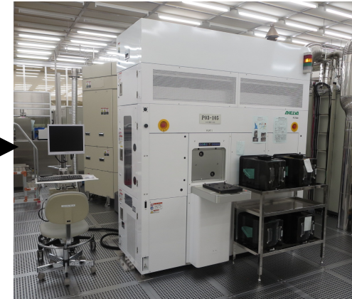
300mm ウェハ上のシリコンフォトニクス工程において、Si光導波路に接続したGe受光器や変調器を実現するためのSiGe成膜装置
