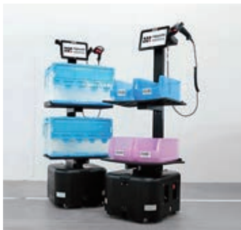
物流倉庫内におけるピッキング作業の省人化・自動化を可能にするヒト協働型ピッキングアシストロボット
