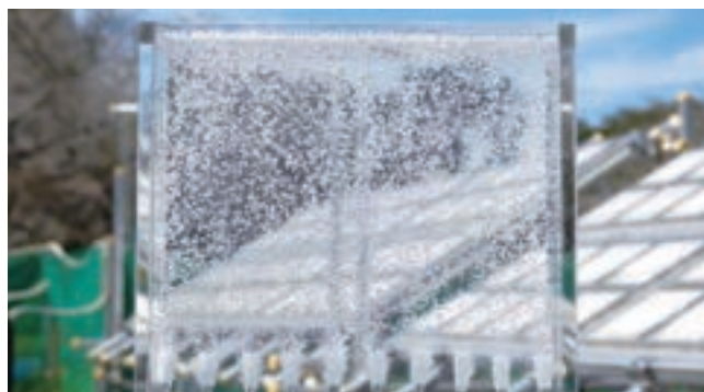
光触媒パネルから生成したH 2 とO 2 の混合気体
