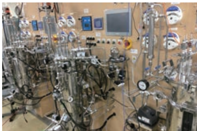
実用化検証／バイオものづくりプロセス開発に用いる30L規模の微生物培養槽
