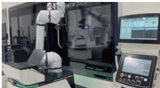
加工アシスト機能を搭載した多能工自走ロボット
