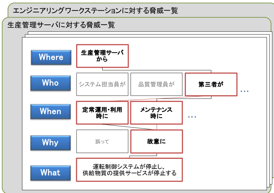
図 14 : 主要事業の運転制御システムの脅威分析における 5W 法の例
