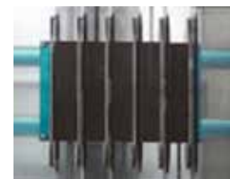
試作された高感度メタ磁性材料と5段カスケード型AMR
