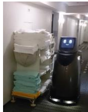
リネンが置かれて幅 1.0m となったホテル通路での狭路走行実証
