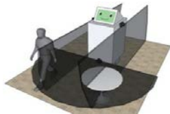
認識した障害物の周囲一定範囲（回避領域）を避けて走行
