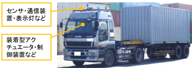
コンテナ搬送自動化ロボット（試作機）により自動走行する既存トレーラ
