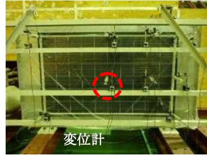
図Ⅲ-2-④-(3)-22 小型の動風圧試験装置（左：装置全景、右：変位計の取付状況）
