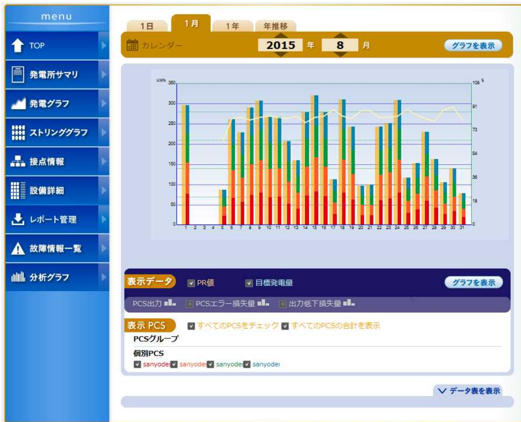
図Ⅲ-2-②-(2)-10 発電モニタ「月プロフィール」
