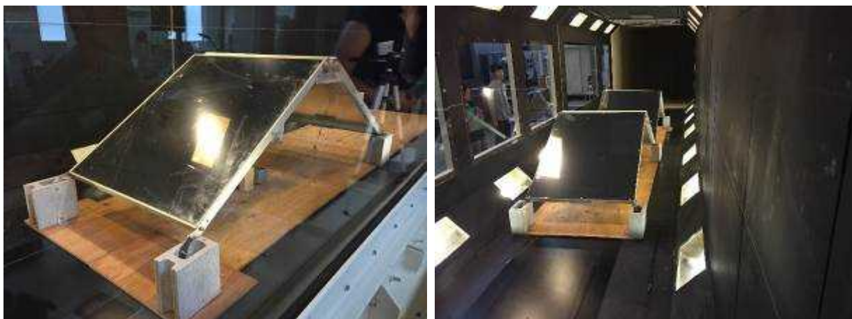
図Ⅲ-2-①-(3)-12 実物大モデルでの風洞実験
