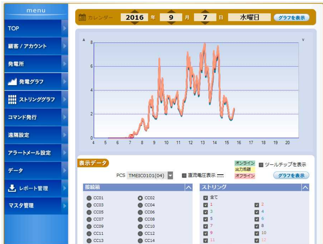
図Ⅲ-2-②-(2)-13 発電モニタ「ストリング監視画面」
