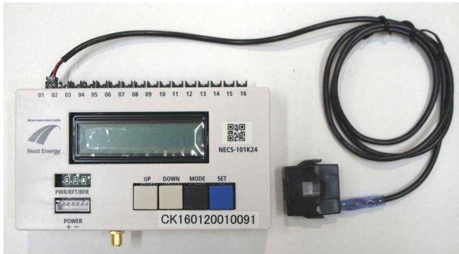
図Ⅲ-2-②-(2)-6 後付けストリングモニタシステム
