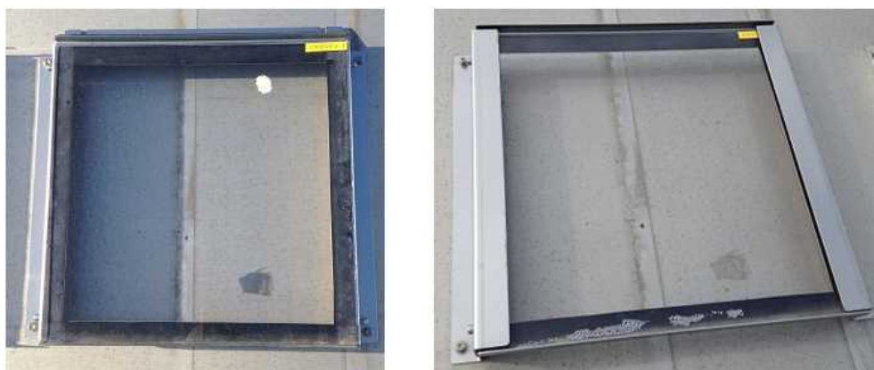
図 III-2-②-(4)-13 雨の後のコート面上の鳥糞
