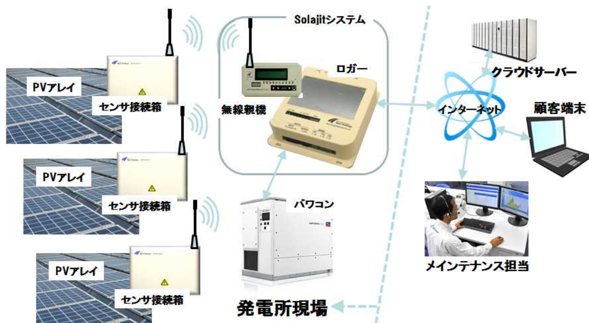
図Ⅲ-2-②-(2)-8 遠隔監視システム
