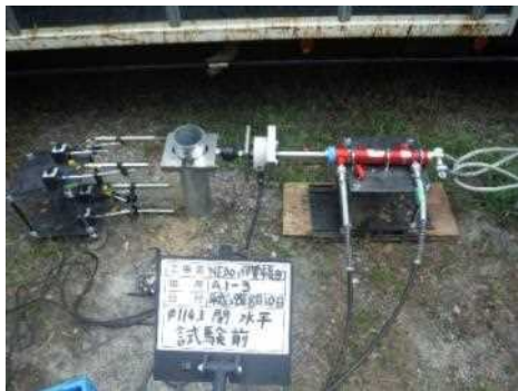
図Ⅲ-2-④-(3)-6 水平載荷試験状況
