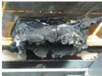
①モジュールの破壊やジャンクションボックスの事故例調査
