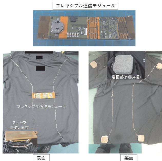
図Ⅲ-2.2.4-6 フレキシブル通信モジュールと心電図測定ウェア
