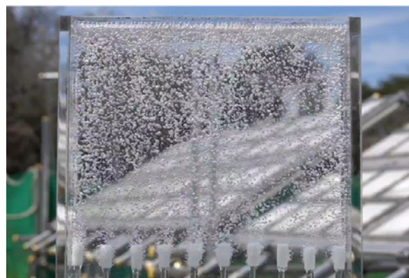
光触媒パネルから生成した H 2 と O 2 の混合気体 (2021年8月26日NEDOニュースリリースより)
