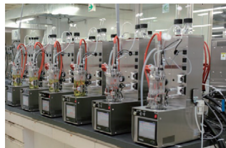
実用化検証／バイオプロダクション人材育成に用いる小規模流加培養槽
