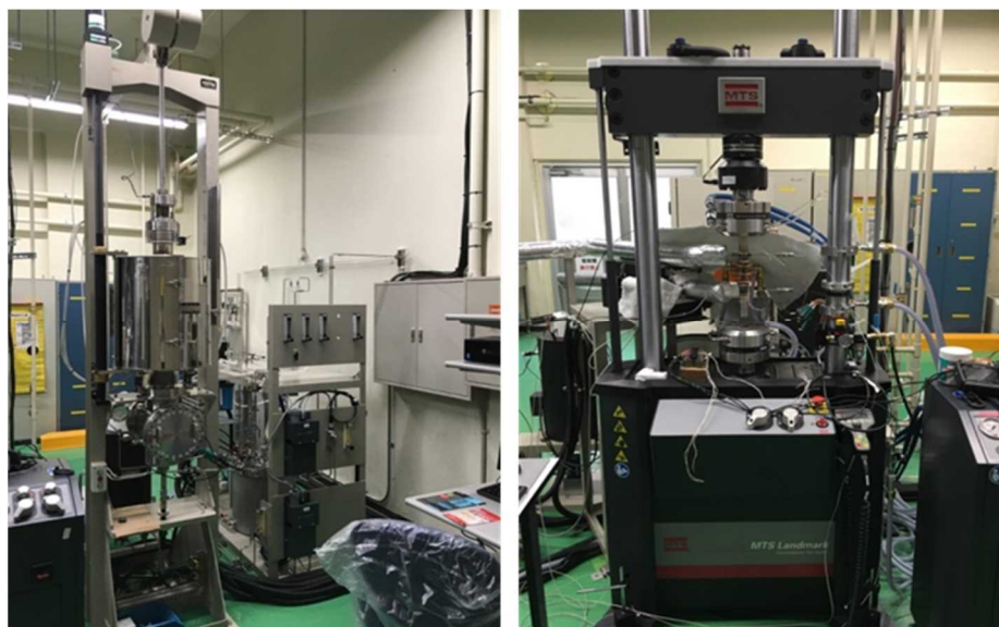
図 3-4 水蒸気環境中クリープ試験機および水蒸気環境中疲労試験機
