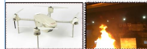
図1 今回開発した300℃耐火型ドローンの製品標準品。QC730FP。
