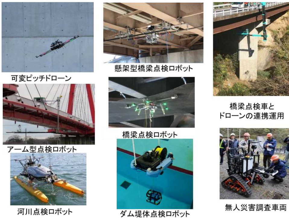
図 2-4a-6 課題抽出・改良のために実施した現実のインフラ施設を使用した実証実験の例 (ロボット分野)
