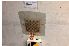
複数台の中継機により電波環境の悪い監査廊内部から屋外までセンサデータを送信できることを確認
