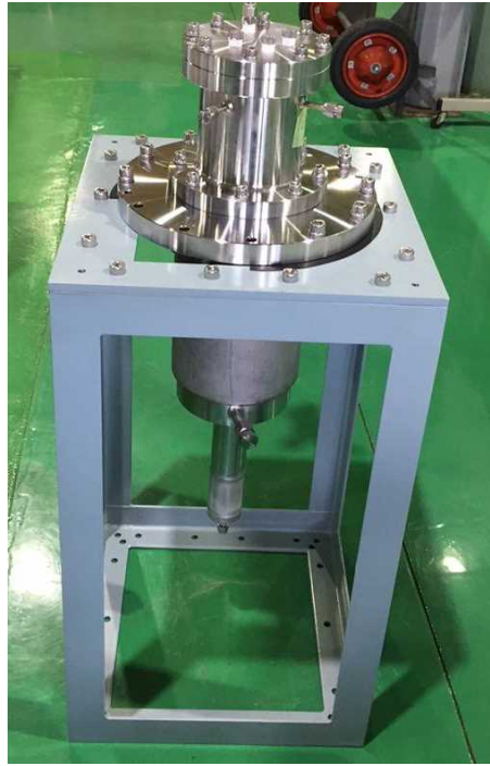
図 2.1.2-8 液体窒素循環ポンプの外観
