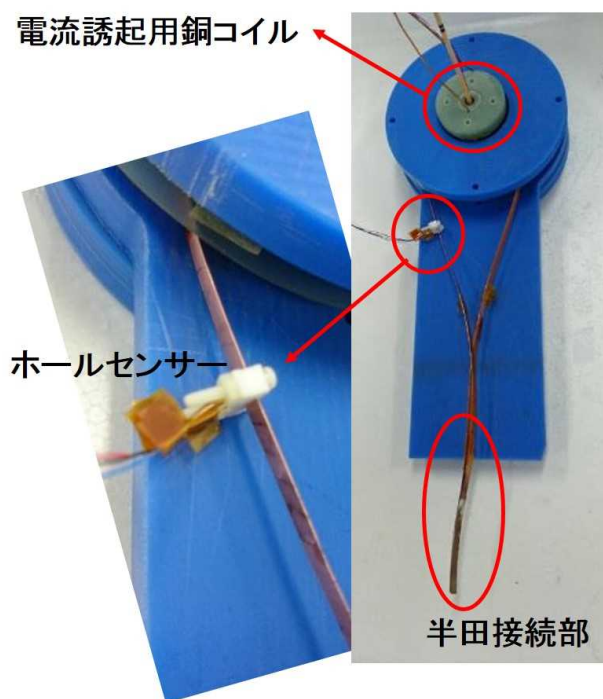
図 2.3.5-2 液体窒素中での接続抵抗評価予備試験のためのセットアップ
