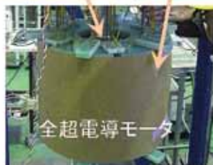
ALCA(JST先端的低炭素化技術開発)で開発中の全超電導モータ(鉄不使用)
