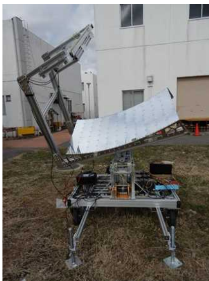
図. III-2-③-19-6 軽量ムーバブル低倍率集光太陽光発電システム 2号機の外観写真
