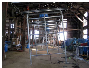
<図Ⅲ-2-①-18-6 : 台風を想定した引張試験>
