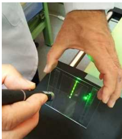
図Ⅲ-2-③-15-22 反射のたびに光量が漏れる現象
