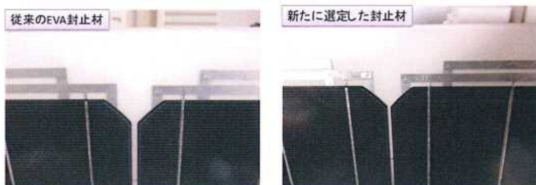
図 III-2-①-9-1 温水試験評価後のモジュール外観
