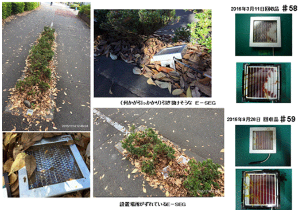
図Ⅲ-2-③-16-14 落ち葉で埋没したり踏まれたE-SEG
