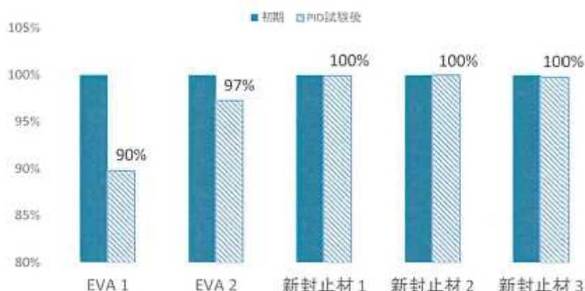
図Ⅲ-2-①-9-2 PID 試験評価結果
