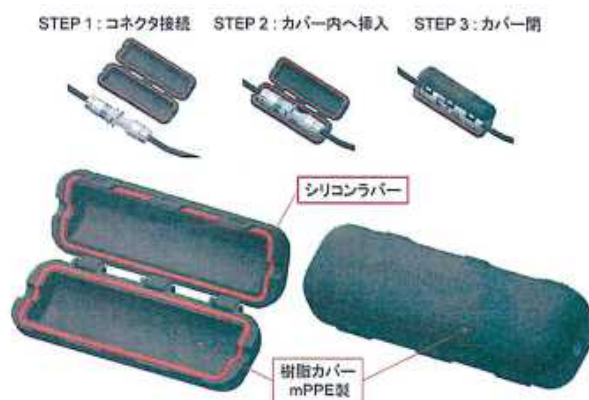
Ⅲ-2-①-9-5 モジュール間接続部用コネクタカバー
