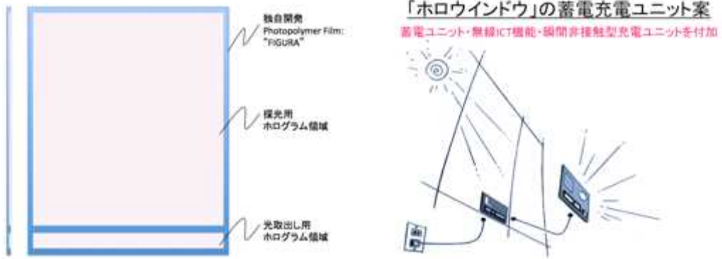
図Ⅲ-2-③-15-25 後付け対応光取出ホログラムの構成模式図と、蓄電充電通信機能付き太陽光発電ユニット案
