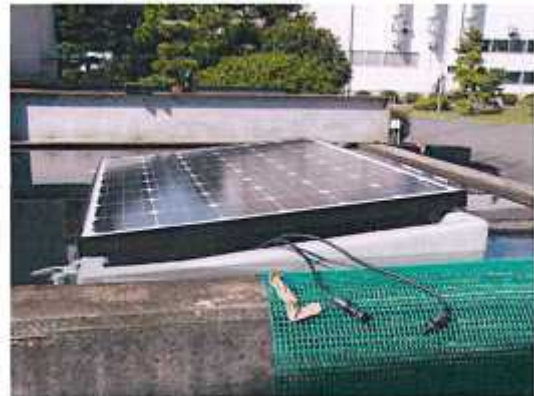
Ⅲ-2-①-9-3 海上設置架台写真（左：浮き子方式 右：FRP方式）
