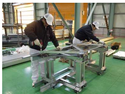
図Ⅲ-2-①-7-12 工場によるプレファブ化 (ユニット架台)
