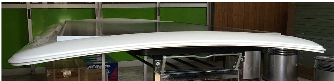
図Ⅲ-2-①-4-12 Ver2 試作品 太陽電池組付状態 真横図
