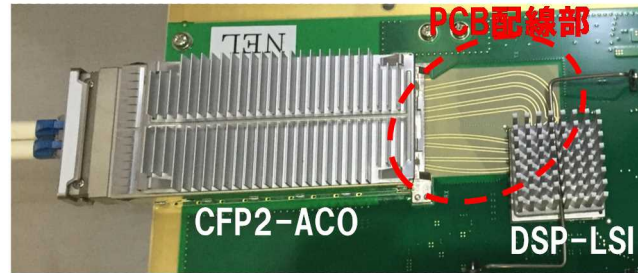
図Ⅲ-2.2.2.3-5 CFP2-ACO と DSP-LSI 間を接続する PCB 配線例
