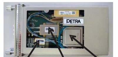
光送信デバイス 光受信デバイス DSP CFP-DCO 100Gデジタルコヒーレントトランシーバ
