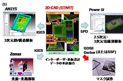
図Ⅲ-2.1.2.4-1 (a)光エレクトロニクス実装システムの構成図と、(b)解析ソフトウェアの連携図
