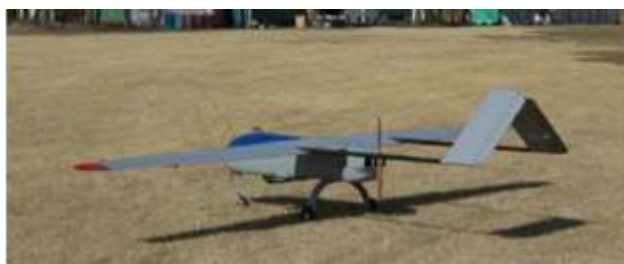
画像システムを搭載した無人固定翼機(東京大学)
