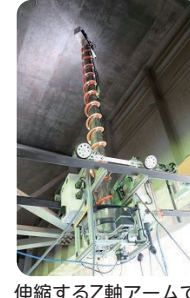
伸縮するZ軸アームで格間内にカメラを伸ばし任意角度から撮影
