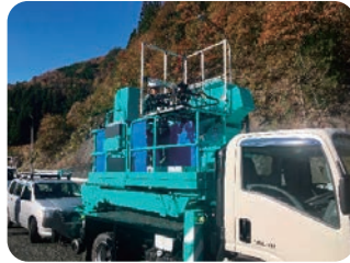
点検車上に設置されたマルチコプタシステム
