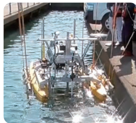
運搬フレームにより4つユニットだけで容易に設置・撤収が可能 (作業者の水上作業なし)
