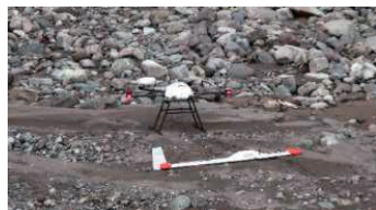
電磁探査装置と大形無人調査ヘリ
