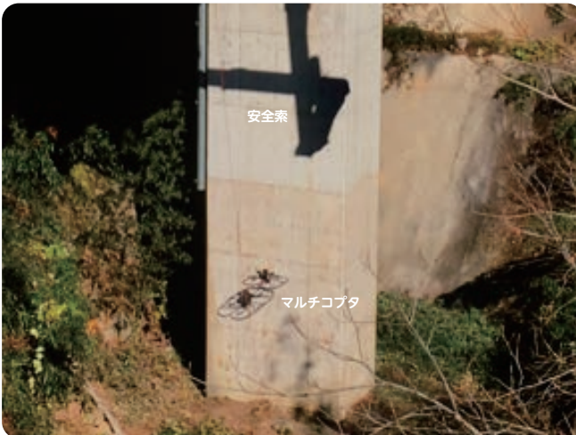
バケットから離陸し、橋脚柱との離隔を自動的に1mに保持して画像を取得
