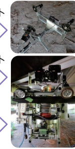
X軸・Y軸駆動部で橋梁下に自在に移動
