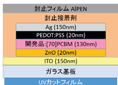
図 1.1.3.2.2-3 ガラス基板素子の構造
