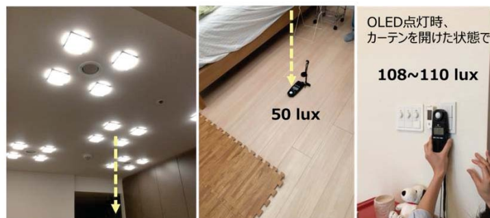
図 1.2.2.5-2 居住空間でのセンサ設置位置と照明の調光
