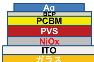
図 1.1.2.5-4 NiO 膜を用いた素子の構造
