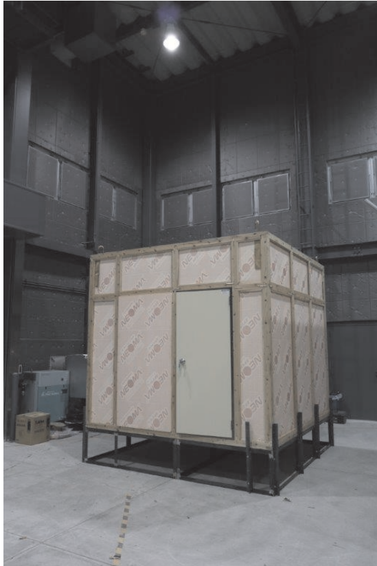
図 2.2.4.2.1-1. 労安研配管等爆発実験施設に設置された漏洩拡散挙動計測用模擬室
