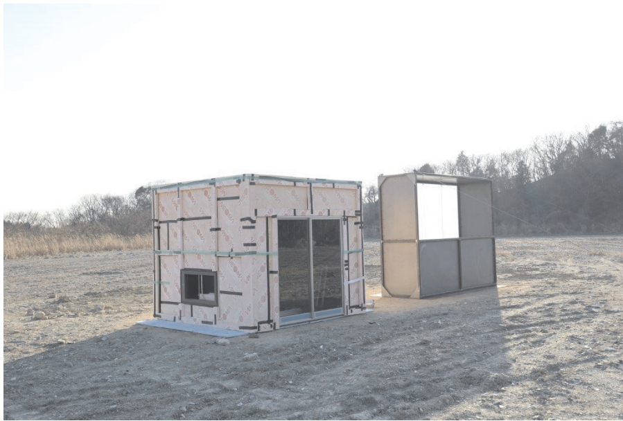
図 2.2.4.2.2-1. 断熱材を張った影響評価実験用模擬室（左）と模擬ベランダ（右）
