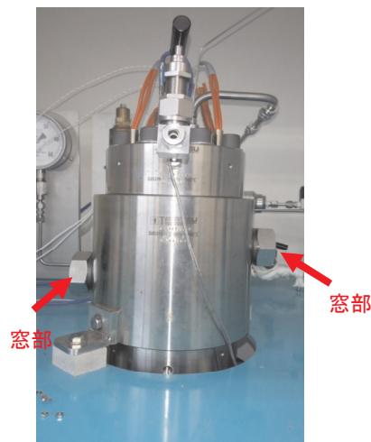
図 2.2.3.3-2 不均化反応試験装置写真
