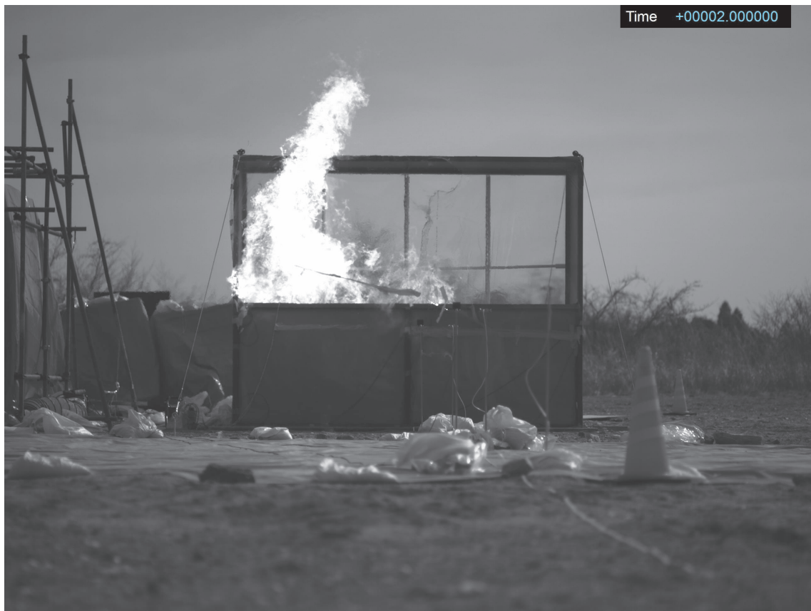
図 2.2.4.2.4-2. 模擬ベランダ正面から撮影したモノクロ高速カメラ映像 野外実験 2-2、点火後 2.0 秒
