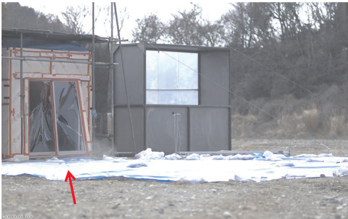
図 2.2.4.2.2-5. 模擬室前方 45° から撮影したカラー高速カメラ映像 野外実験 1-2、点火後 0.7 秒
