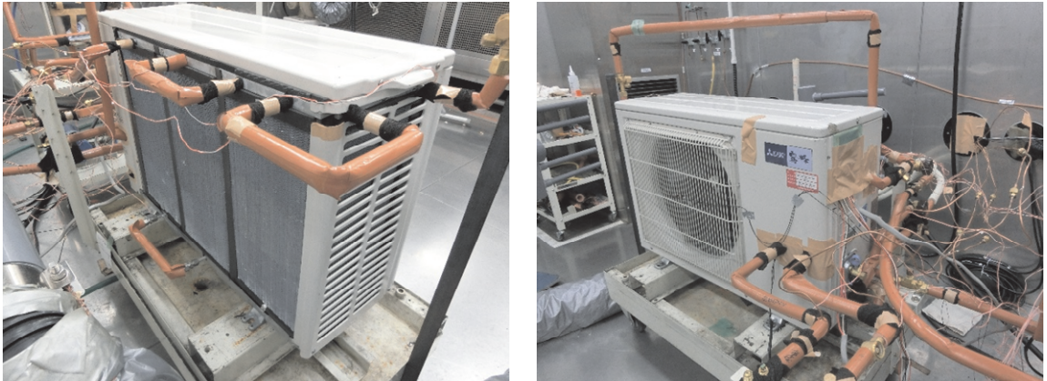
図2.1.3.2 高効率/省冷媒熱交換器搭載ユニット試験使用の室外機
