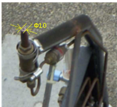
図 19 水素燃焼に用いた火口
