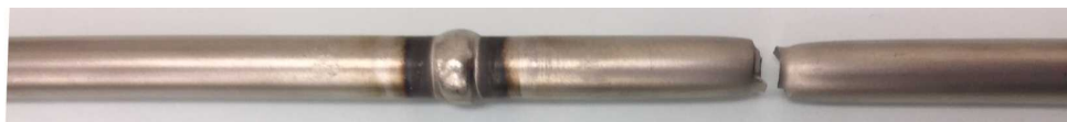
図 3.9 母材 + 5%Cr のインサートリングを使用した配管溶接継手の引張試験片の破断の様相 溶接条件[「Ar + 50% He + 2% N2」: (シールドガス Ar + 50% He + 2% N2, バックシールドガス N2)]
