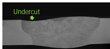
溶接の断面図(インサートリング無し)
