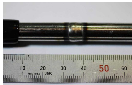
図 3.25 内圧模擬疲労試験に供した溶接配管
