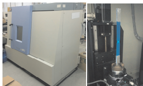
図 34 X線CT試験機および試験片の外観
