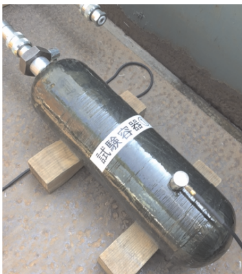
図 27 小型複合容器と AE センサの外観
