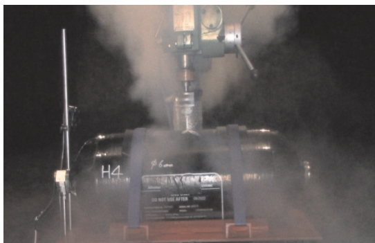
図 3.9 CFRP 容器の穴あけ時状況
