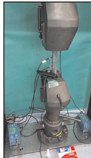
図 13 CFRP 引張破壊試験
