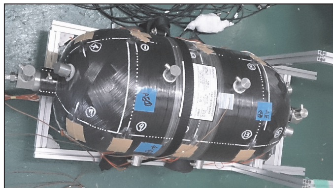
図 15 複合容器(45MPa,30 )と AE センサの外観 ( JPEC 殿提供写真 )
