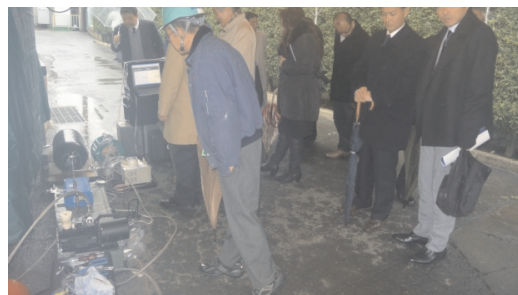
図 3.13 くず化業者での真空引き試験
