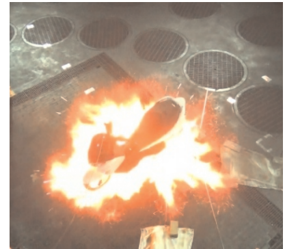
図 3.15 安全弁作動時の状況
