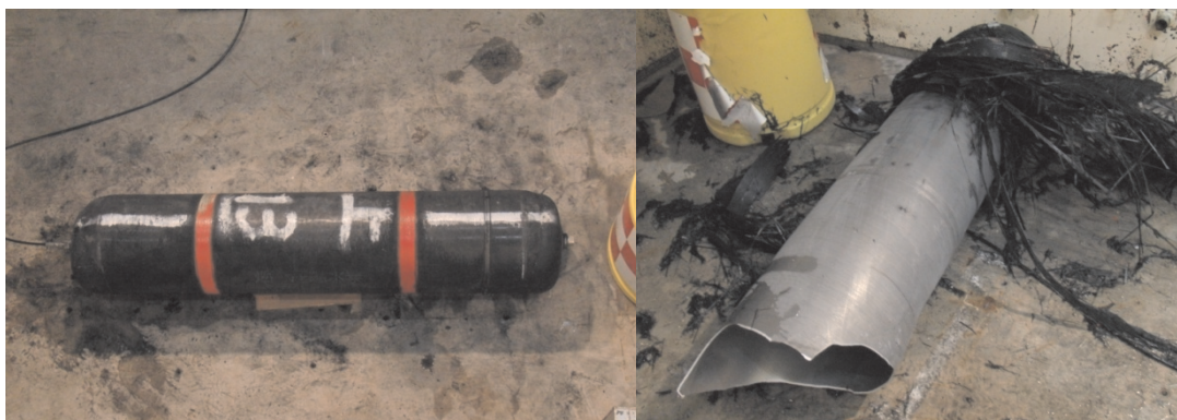
図 3.14 焼損容器の残存強度確認試験
