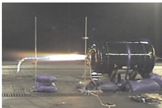
図 3.11 容器内の残留水素に引火試験
