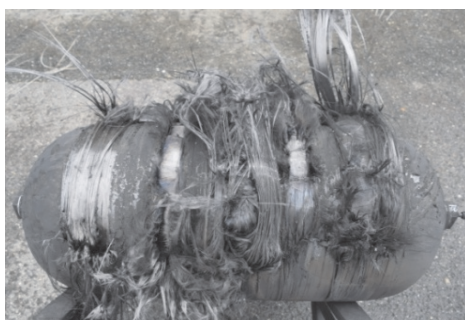
図 3.6 破裂直前に水冷させた容器
