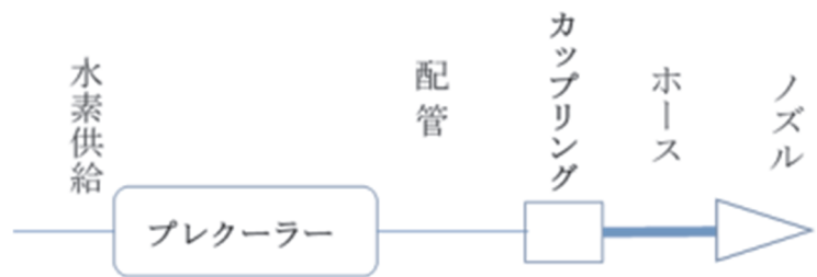
図8 プレクーラー - からノズルまでの流れ
