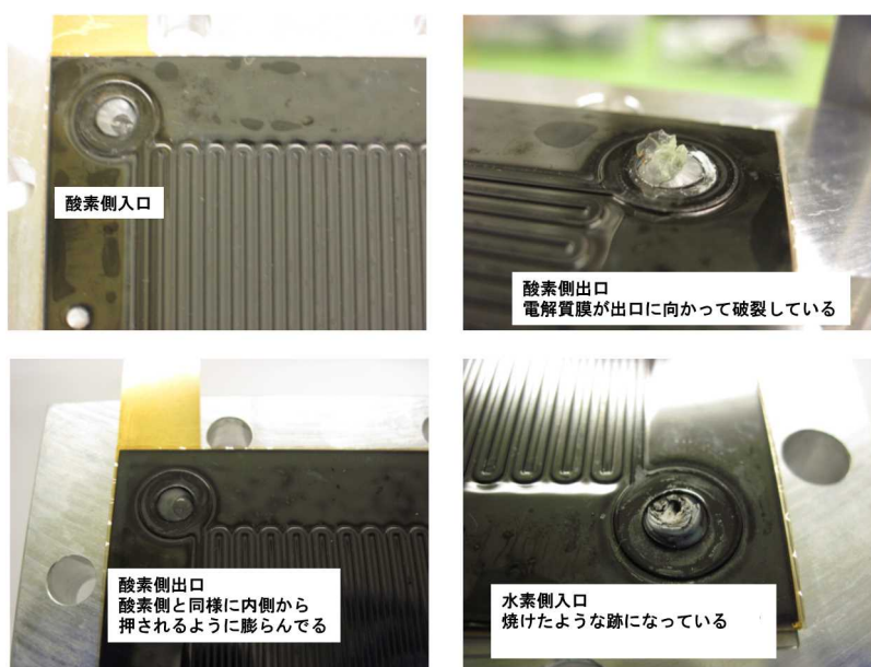
図 23 発電試験後のセパレータ (分解 2) : 外部拡大ナフィオン膜破損
