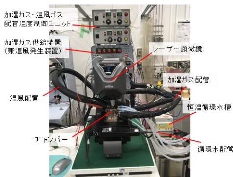
図C-②-1-3 環境制御型かさ計測システム
