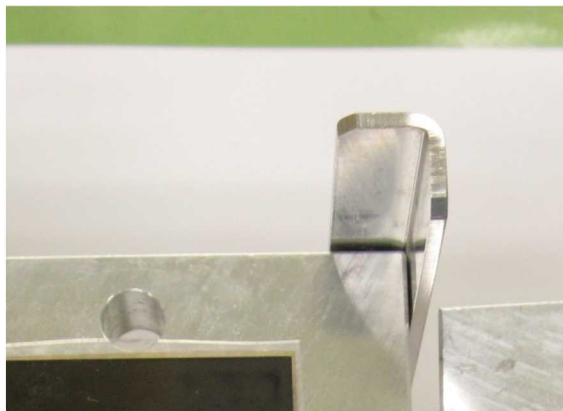
図 22 発電試験後のセパレーター（分
