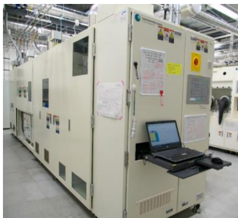
図Ⅲ-2- (ロ) -1 -②-c-1 導入した高速製膜用 MOCVD 装置
