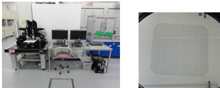
図Ⅲ-2-(二)-B-8 注入マスク位置合わせ装置装置と注入マスク
