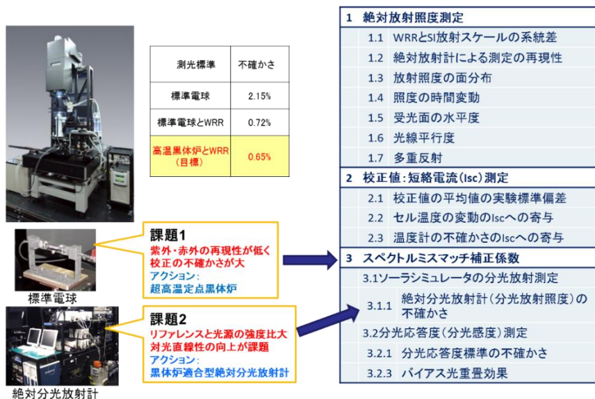
図Ⅲ-2-(ホ)-A-1-②-1 基準太陽電池の一次校正における不確かさ要因と技術課題。拡張不確かさ(U95)0.65%はこれらの項目すべての不確かさ要因の二乗和の平方根を2倍したものである。
