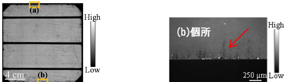
図Ⅲ-5-(イ)-F-2 試作セル分光感度マッピングおよび PL イメージングでの評価例
