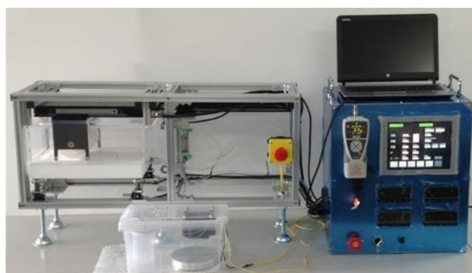
図Ⅲ-2- (ロ) -1 -②-a-21 タカノ㈱にて開発のローラー型 ELO 装置
