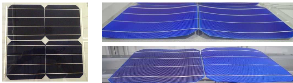
図Ⅲ-2-(二)-B-12 厚さ 80 \mu\text{m} のセルを用いて作製したモジュールとタブストリング作製でのウェーハの反りの様子
