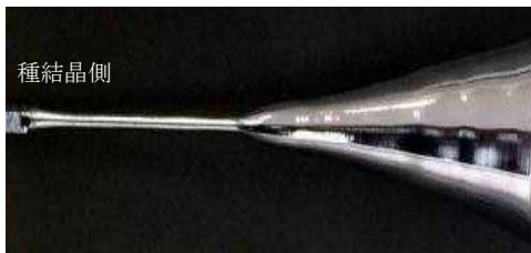
図III-2-(イ)-E-9 実際のネッキング品
