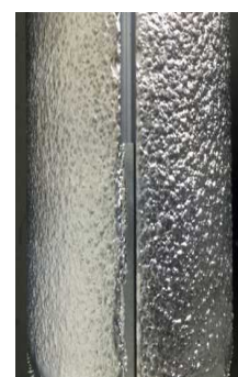
図Ⅲ-2-(イ)-E-5 ドーパントを溶着した 多結晶シリコン棒
