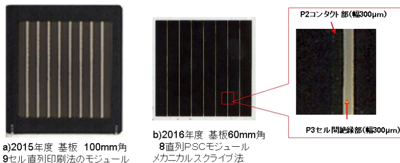
図Ⅲ-2-(ハ)-D-9 60mm角基板に 8セル直列接続したモノリスモジュール (右)
