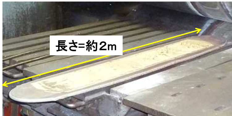
図Ⅲ-2.4.2-2 実機規模の試験で得られた熱間圧延後の薄板
