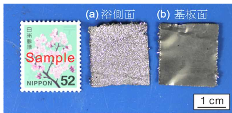
図III-2.4.2-3 電析によって得られたチタン
