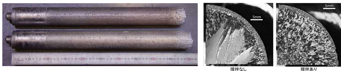
図Ⅲ-2.2.1-1 電磁攪拌による鋳造組織微細化技術の開発
