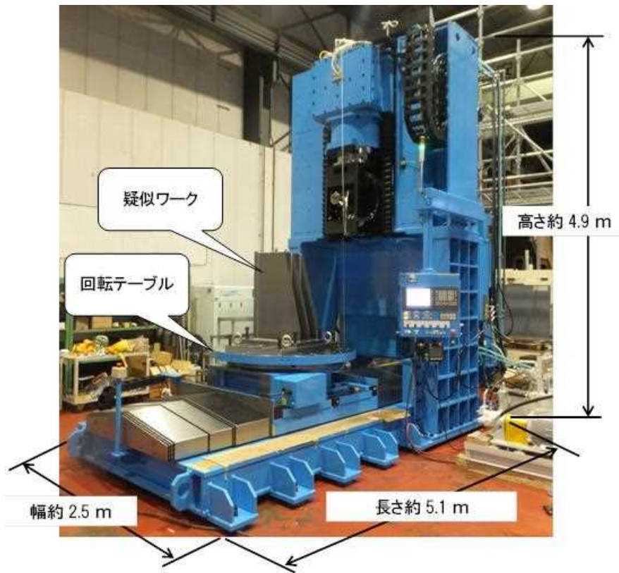
図Ⅲ-2.7.8-5 FSW 装置外観写真
