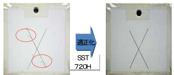
図-III-2.3.5-3 SSTでの糸錆改良
