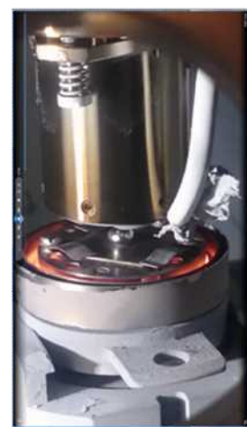
図Ⅲ-2.1.2-26 試料Bへ熔融亜鉛を滴下した際の液滴
