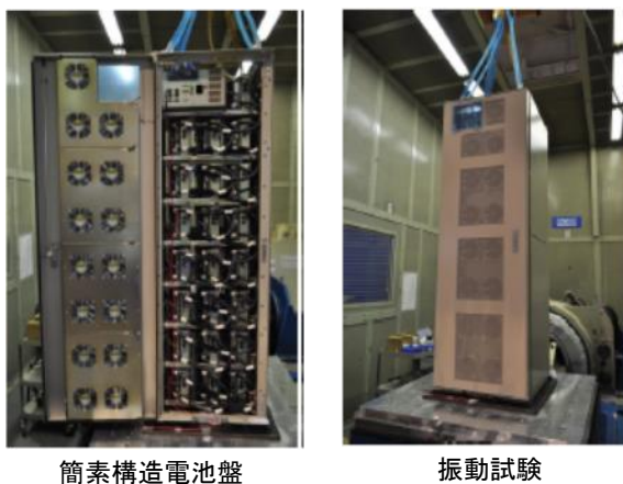
図Ⅲ-13 電池盤の振動試験
