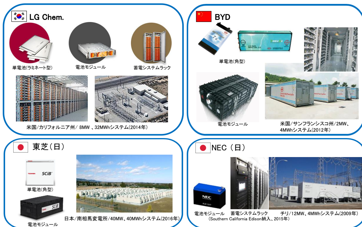
図 I-32 代表的企業の大型リチウムイオン蓄電池システム
