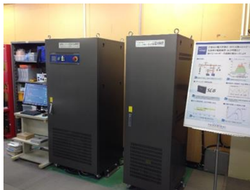
図Ⅲ-47 測定対象太陽光発電太陽光発電用蓄電池システム
