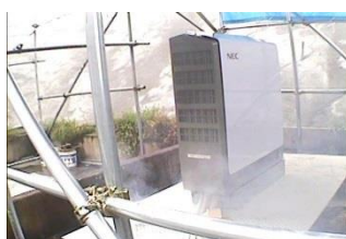
熱暴走による強制発火で、数秒間発煙
