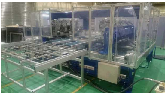
図Ⅲ-2-③-(3)-1 アルミフレーム除去装置完成写真
