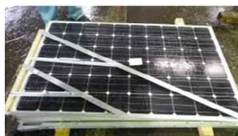
変形・破損なし
