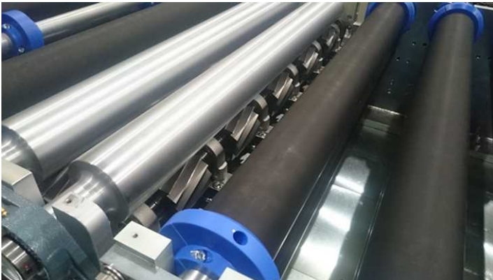
図Ⅲ-2-③-(3)-7 バックシート除去装置の回転切削刃部
