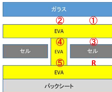
図Ⅲ-2-③-(2)-4 太陽電池モジュール断面 (模式図) におけるEVA分析サンプルの採取場所 (①～⑤及びR)
