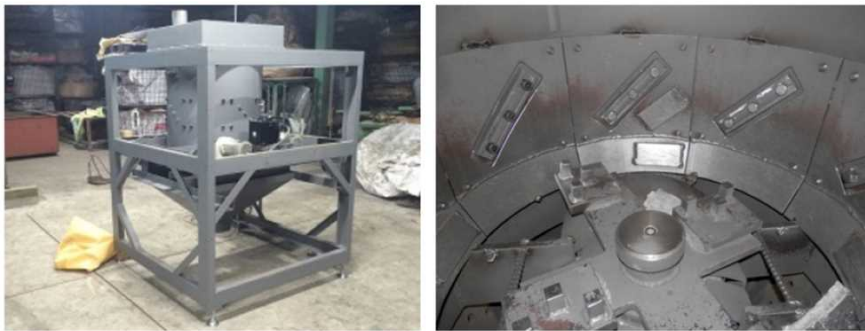
図III-2-②-(3)-7 ハンマー式破碎剥離機（左：外観、右：内部）
