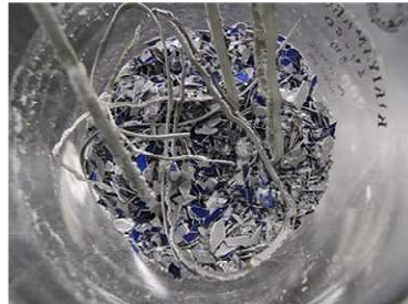
図Ⅲ-2-②-(4)-9 ガラスを切り剥がした太陽電池モジュールから回収された金属およびシリコン
