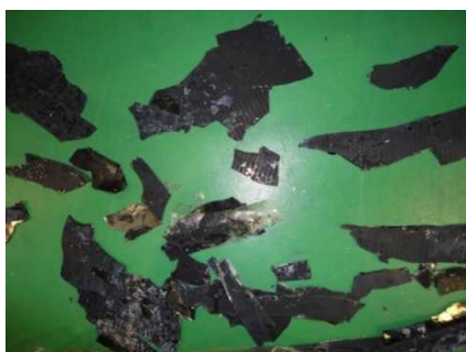
図Ⅲ-2-③-(4)-4 合わせガラスの予熱温度を高温化（約 270℃）した場合の基板ガラスのナイフの刃への到達前の割れ方 パネル送り速度：1mm/秒 ガラス片の大きさ：50～200mm×100～300mm 程度
