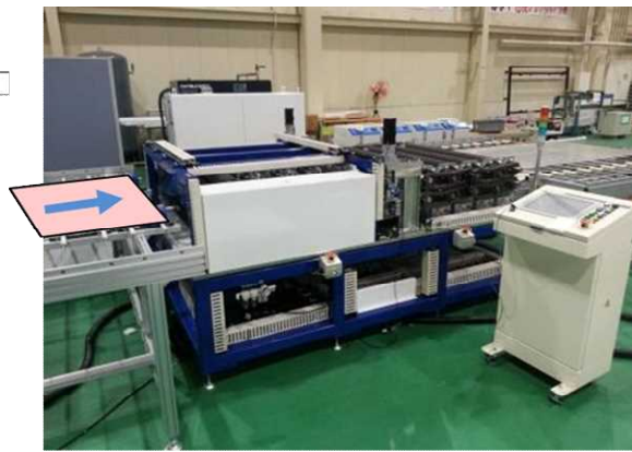
図Ⅲ-2-②-(4)-2 ガラスと EVA/セル分離装置写真
