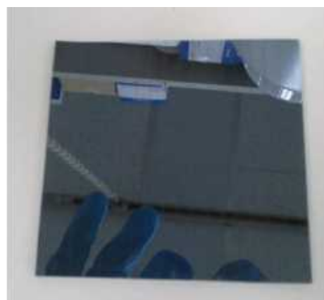
図 III-2-③-(4)-17 CIS 剥離後の基板ガラス (Mo 膜は残っている)
