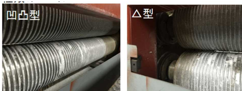
図Ⅲ-2-②-(3)-5 ロールの形状 (左：凹凸型、右：△型)
