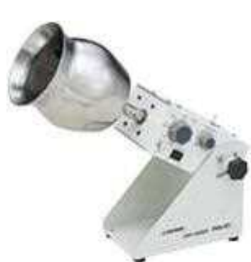
図Ⅲ-2-③-(4)-12 ポットミキサー 傾斜角調節範囲：90° 容器材質：SUS304、回転数：4～56rpm
