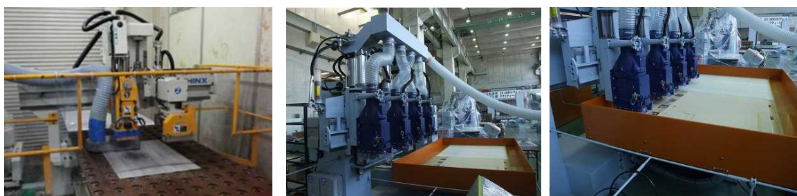
図Ⅲ-2-③-(2)-6 実験評価用研削機（左）とスループット向上させた新規研削機（中央、右）
