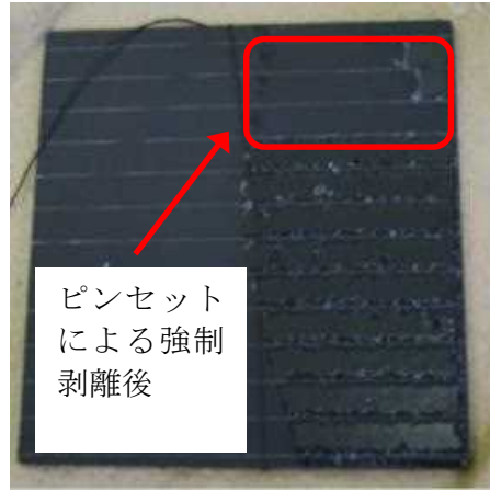
図Ⅲ-2-③-(4)-9 EVA の強制剥離後の基板ガラス
