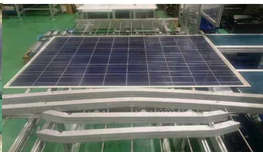
図Ⅲ-2-③-(3)-2 アルミフレーム除去後のモジュールとフレームの状態
