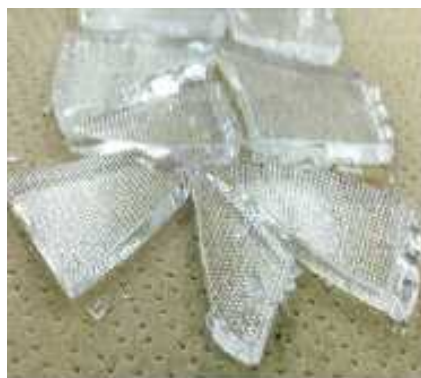
図Ⅲ-2-③-(4)-15 ミキサー中、トルエンで 12 時間処理した EVA 付きカバーガラス
