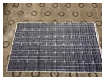
図Ⅲ-2-③-(3)-23 写真c):EVA/セル層 破砕なし
