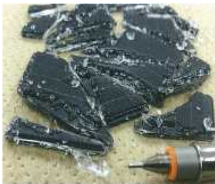
図Ⅲ-2-③-(4)-14 ミキサー中、トルエンで 12 時間処理した EVA 付き CIS 基板ガラス
