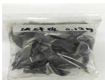
図Ⅲ-2-③-(3)-22 写真b):EVA/セル層破砕
