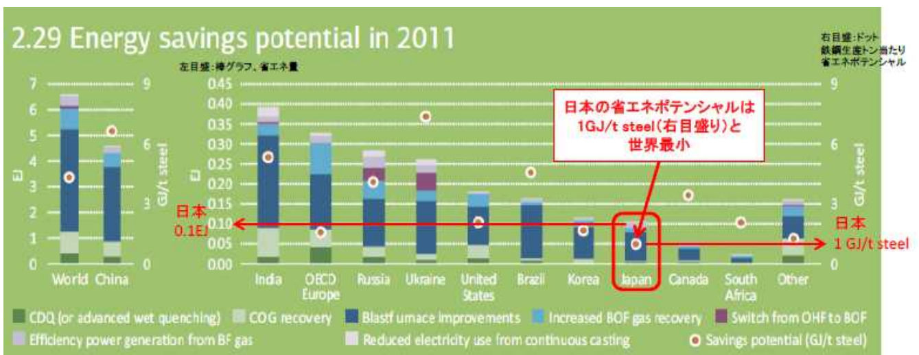
鉄鋼業のエネルギー消費量削減ポテンシャルの国際比較 出所:『Energy Technology Perspective 2014』国際エネルギー機関(2014年5月発表) 注:棒グラフ(左軸)はBAT(Best Available Technology)を適用した場合のエネルギー消費量の削減ポテンシャル 丸印(右軸)は粗鋼トン当たりの削減ポテンシャル
