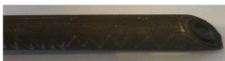
24hr.レースウェイ燃焼試験後のランス外観: 溶損湾曲詰まりなし
