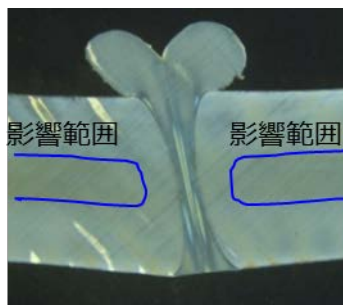
図 3-8 溶着部水素曝露試験結果
