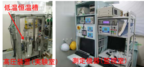
図 29 開発した低温恒温槽 (高圧装置に適用) と測定機器. 遠隔操作により測定可
