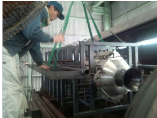
図 5 アルミ型セッティング状況
