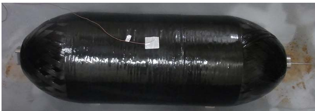
Fig. 8 スチールライナ CFRP 試作容器（30L）の外観
