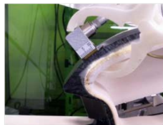
図 15 超音波を融着面に入射して欠陥エコーを検出
