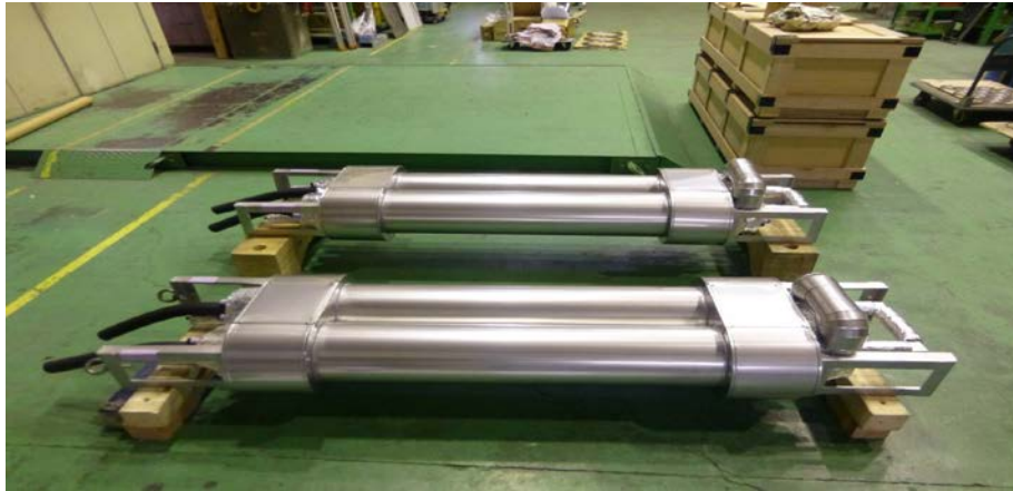
図1. 熱交換器ユニット外観（1ユニットに熱交換器2基を格納した状態） 熱交換器の研究開発は、計画通りの成果を達成した。
