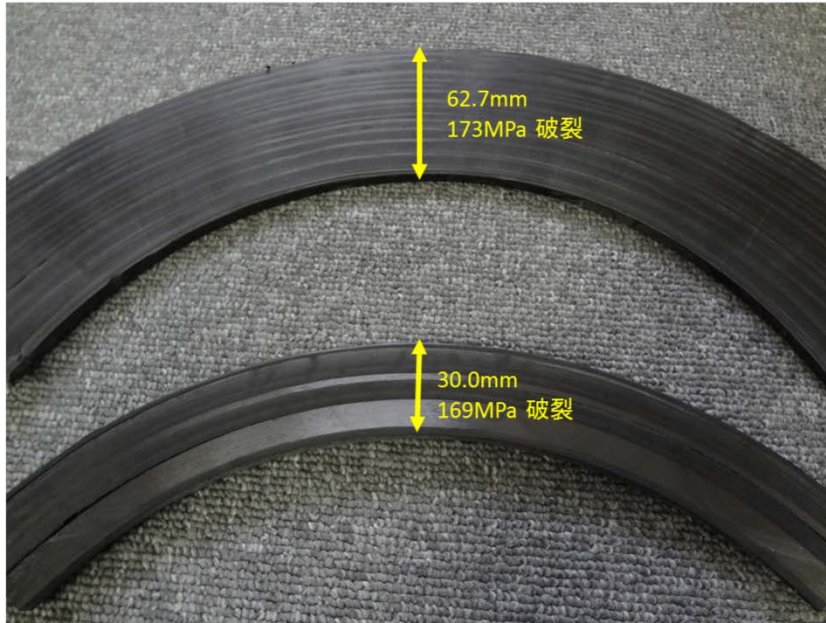
図 32 30L CFRP 補強層切断面
