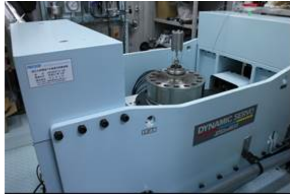
図 13 140MPa 共振疲労試験機(水素ガス圧力:140MPa、試験温度:-50 ~ 300℃、試験周波数:最大 30 Hz)
