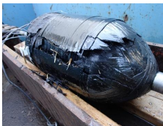
Fig.4 破裂試験後の容器外観
