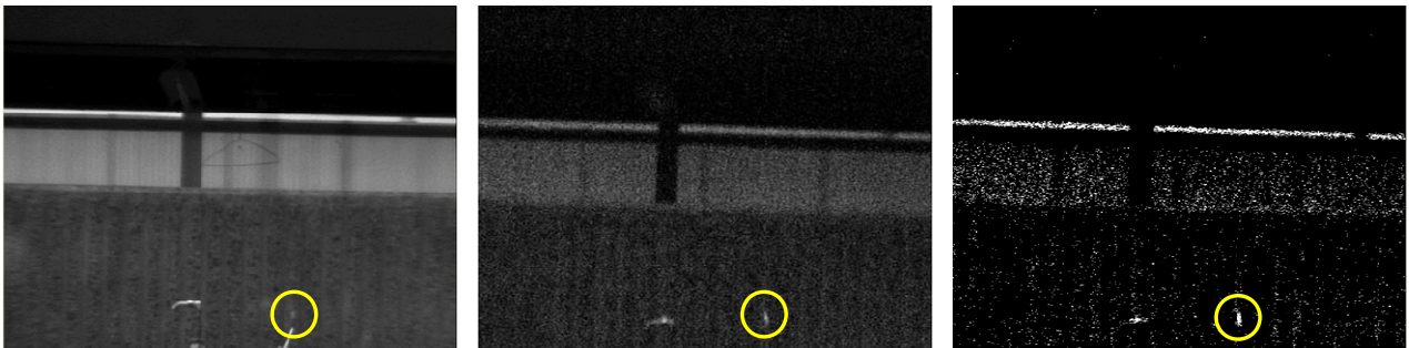
図10 近赤外画像 (左端:766nm、中央:930nm、右端:両画像の差分)
