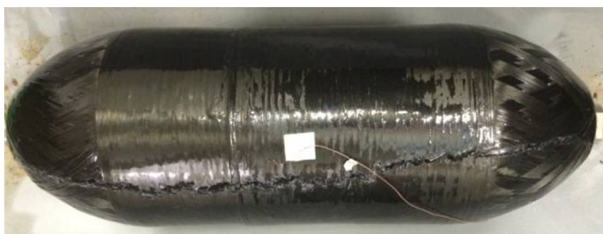
Fig. 9 破裂試験後の容器外観
