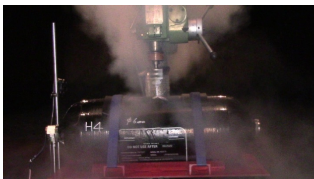
CFRP 容器の穴あけ時状況 (6mmドリル)
