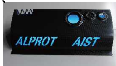
CFRP加工サンプルの例(立体成形品)
