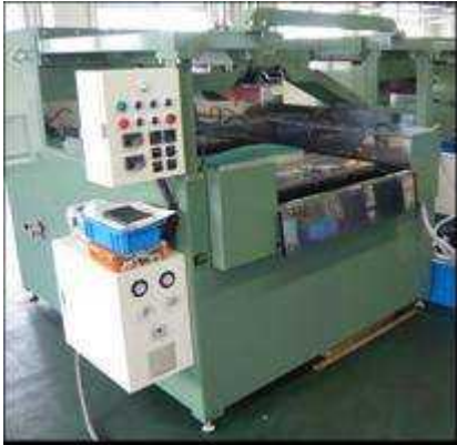
図 III-2.16-1 大型異型レンズ研磨装置の外観(粗研磨/仕上げ研磨共通タイプ)
