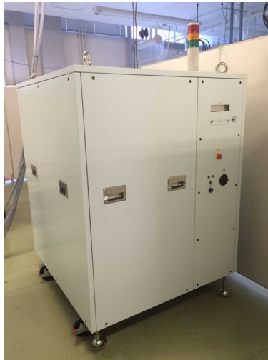
図IV-1.4 6kWマルチモードファイバーレーザー (平成27年度より製品リリース)
