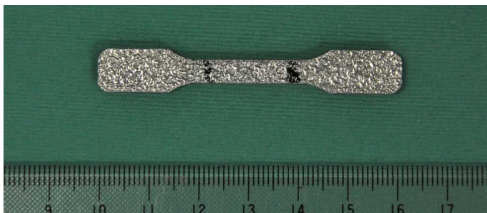
図Ⅲ-2.18.19 実際に作成した引張試験片
