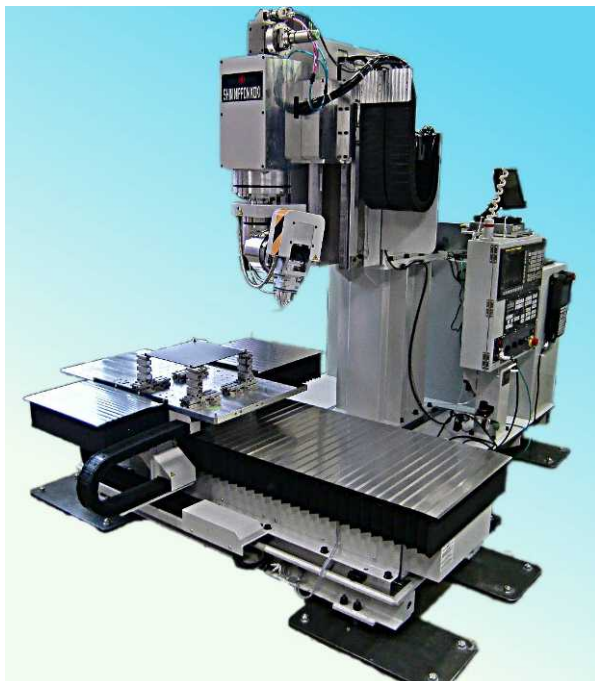
図IV-2.4(2).4 三次元レーザ加工機システム
