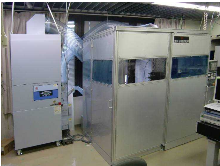
図IV-2.4(2).6 安全キャビン及び集塵システム
