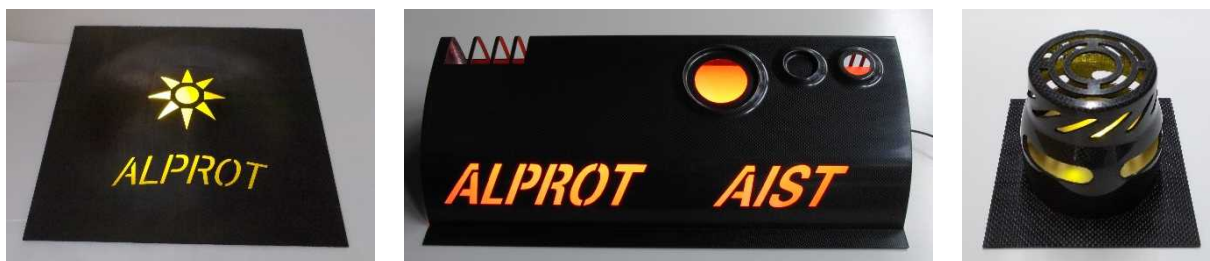
図III-2.6.31 立体成型 CFRP 体へのレーザー加工の例
