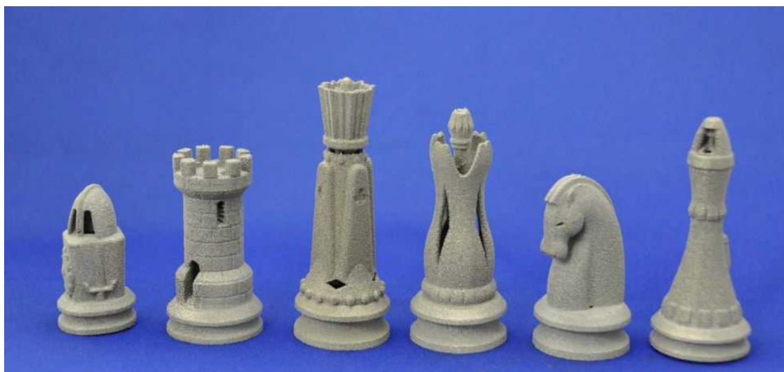
図Ⅲ-2.18.15 小型プラットフォーム試作機で成形したチェスの駒
