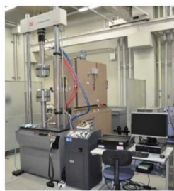
工業規格に準拠した静的引張圧縮試験、疲労試験およびサーモグラフィによる損傷モニタリング
