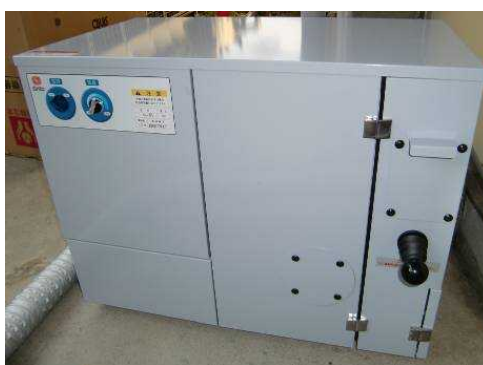
図III-2.6.14 集塵装置外観
