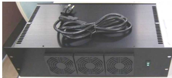
図III-2.6.23 高出力対応ガルバノ/ステージ制御装置外観
