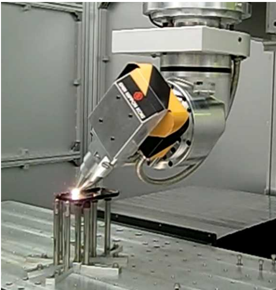
図IV-2.4(2).2 5軸加工機用倣い加工ヘッド
