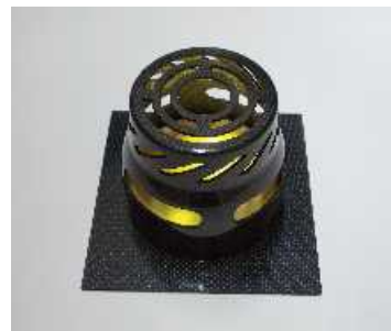
図Ⅲ-1.8 CFRP加工サンプルの例 (立体成形品)
