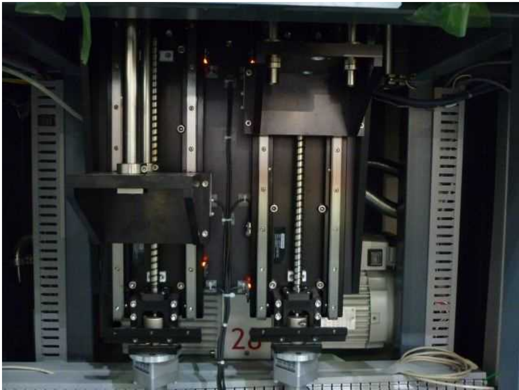
図Ⅲ-2.18.7 ACサーボモータボールネジ駆動方式
