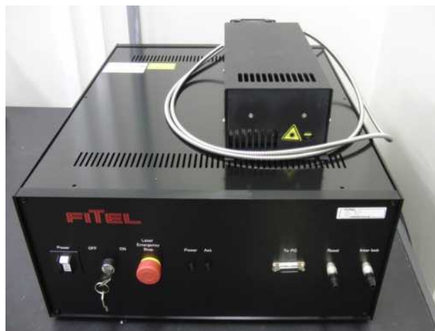
図Ⅲ2.1-10 150W 級パルスファイバーレーザー用シードレーザー
